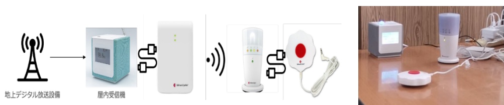
図4 屋内受信機とマルチセンサ発信器等との接続イメージ
